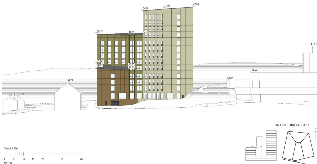
Figur 18. Fasadelevation mot söder och innergården.
