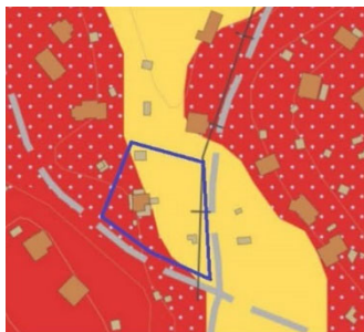
Jordartskarta över planområdet markerat med blå linje. GULT utgör postglacial lera. RÖTT utgör urberg och LJUSBLÅ PRICKAR utgör tunt eller osammanhängande ytlager av morän.
