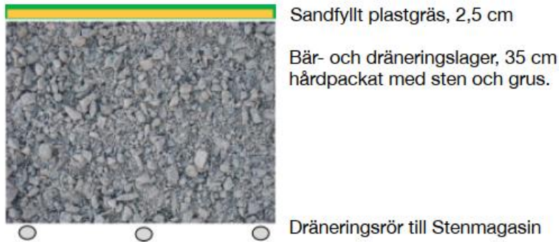
Figur 7. Schematisk profil över tennisbanan med fördröjande egenskaper.
