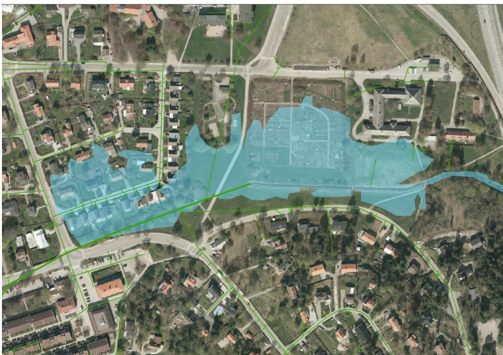
Figur 4. Översvämningsutbredning vid blockerad kulvert och 100-årsregn (+5,4m).
