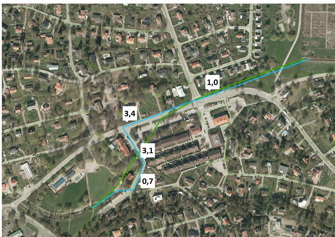
Figur 12. Alternativ bräddväg (blå linje) längs vägen. Siffrorna visar det djup som flödesvägen skulle behöva ha längs sträckan.
