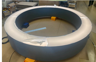
Figur 9 En armatur som sitter runt pelarna mot taket i tunneln ger en jämn ljusfördelning (RGB).
