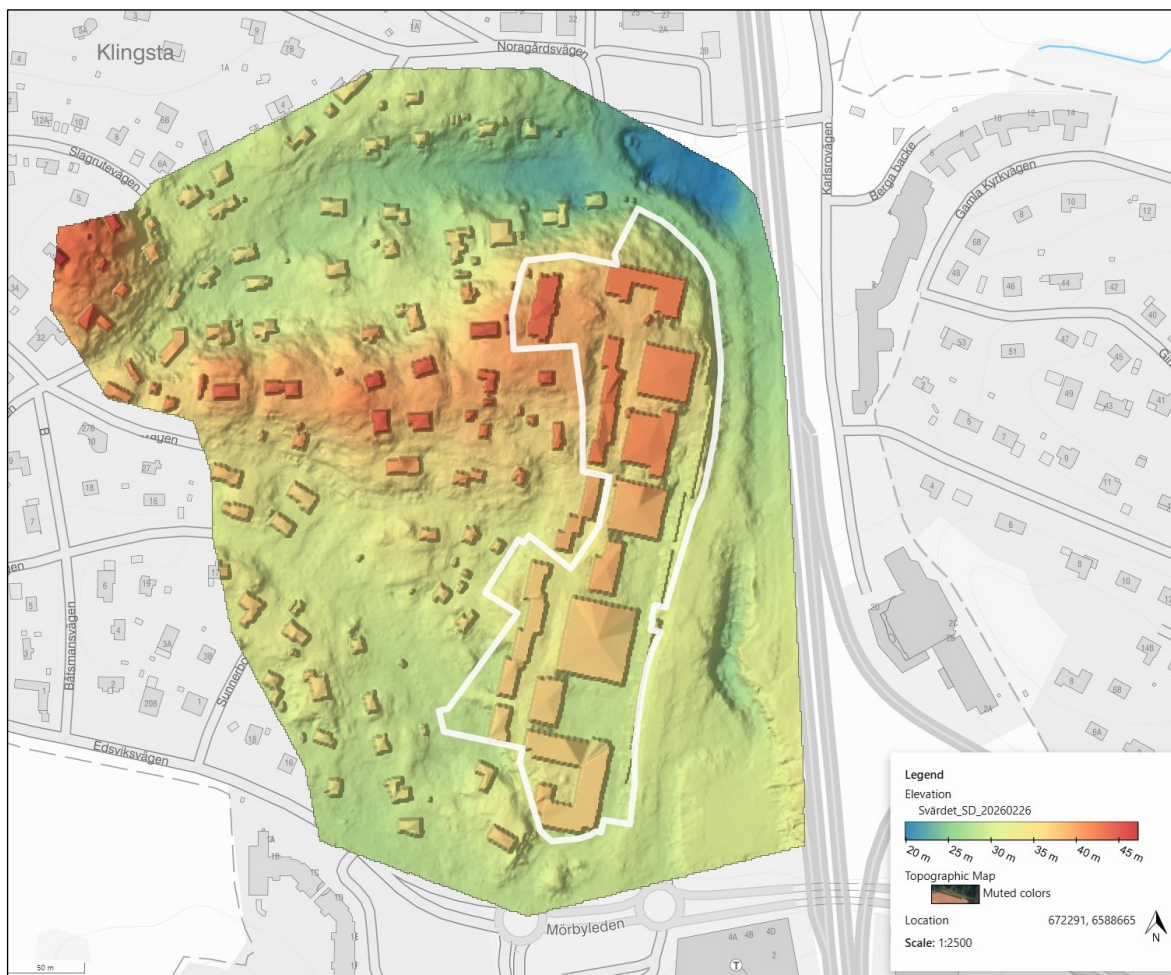
Figur 16. Modellområdets storlek och avgränsning (färgat område). Planområdet är markerat med vit linje (Framtagen i Scalgo Live).
