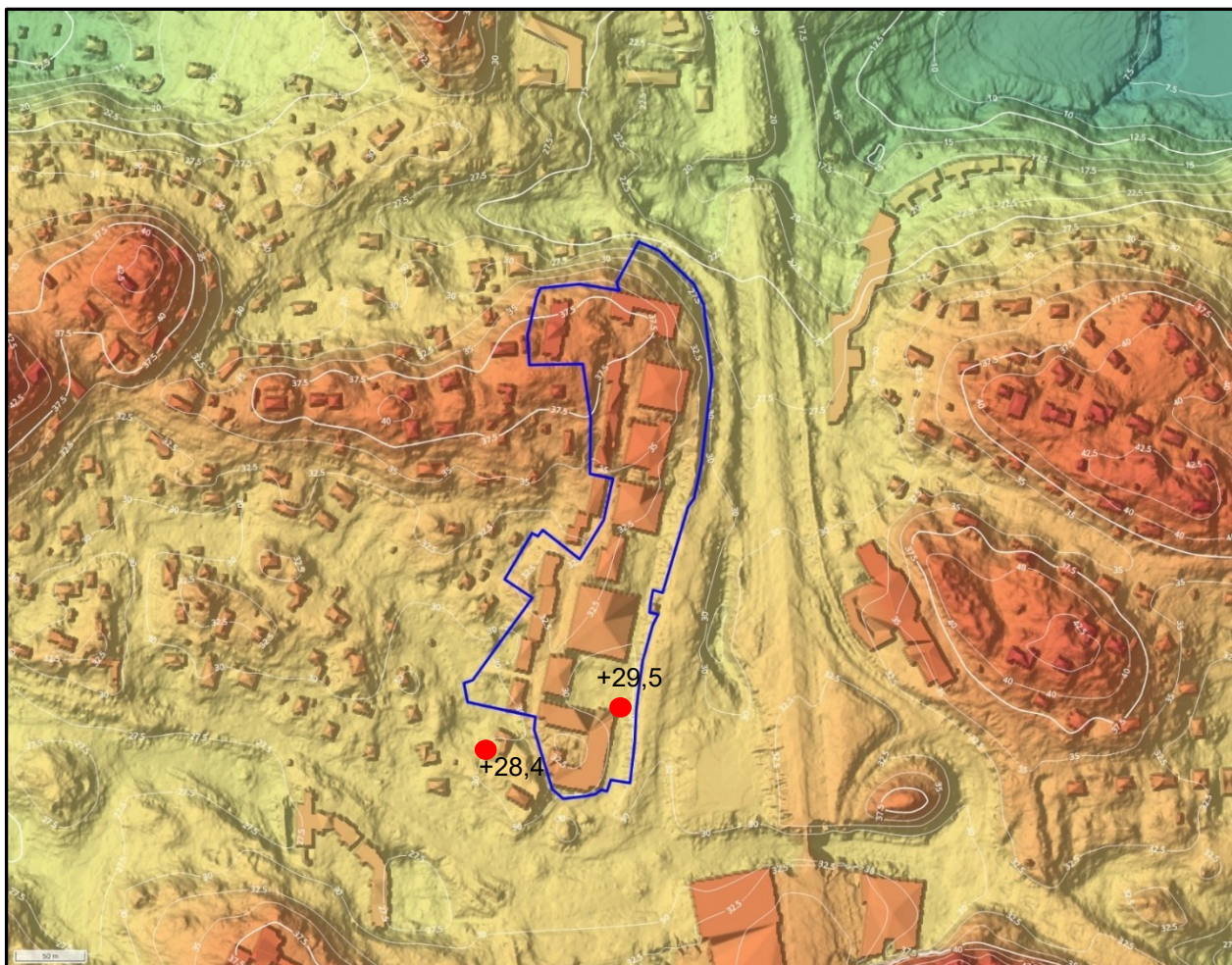
Figur 3. Topografin i området baserat på kommunens höjdmödel. Planområdet visas med blå markering. Figuren är framtagen i Scalgo Live.
